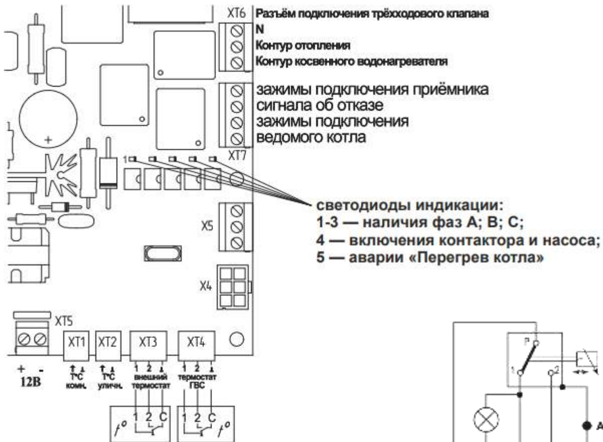
Рис. 1 Схема коммутационной платы котла STOUT.
